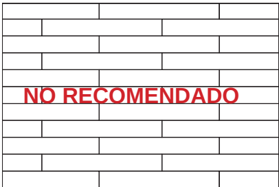
Colocación regular a Media Pieza (no aconsejable)
